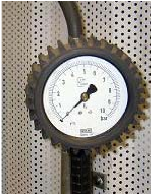
Bild 13. Instrument nr. 1. Används för mätning och justering av lufttrycket i bilens hjul.
