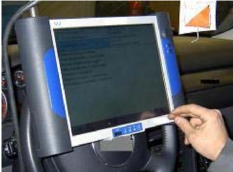
Bild 17. Instrument nr. 5. Används för att kontrollera om några störningar har lagrats i minnesfunktioner som finns i bilen.
