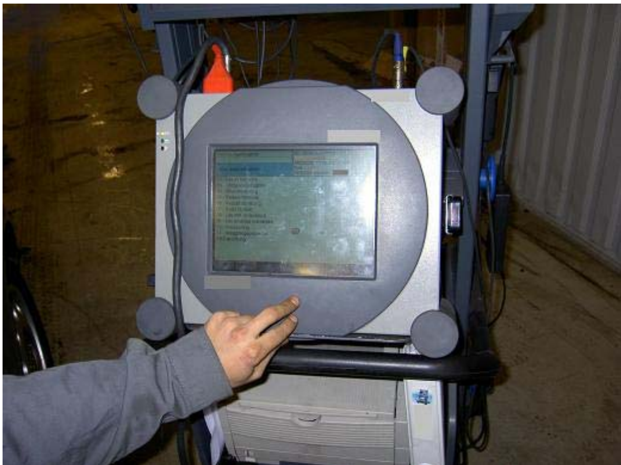
Bild 18. Instrument nr. 6. Används för att få fram en specifik kod för styrning av bilens ABS-funktion.
