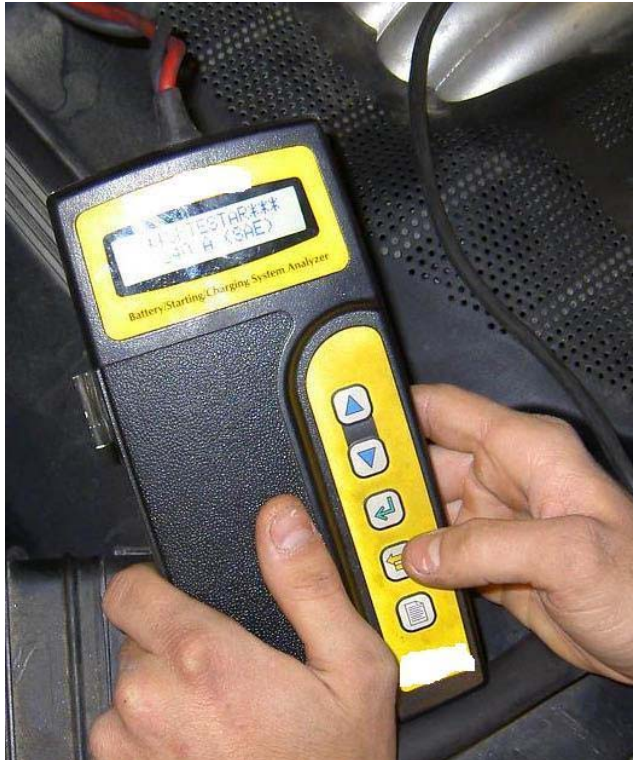
Bild 15. Instrument nr. 3. Används för att kontrollera laddning samt batteriets kondition.
