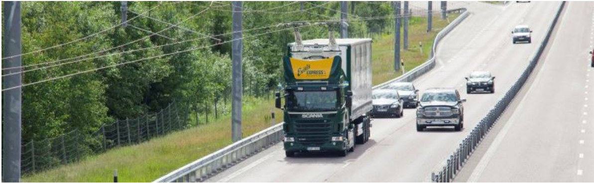
Figur 1: Lastbil med konduktiv laddning på E16 mellan Sandviken och Kungsgården. (Trafikverket 2019)
